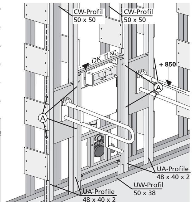
Alle weiteren Montagehinweise entnehmen Sie bitte den Montageanleitungen der WC-Elemente mit erhöhter Fußkonstruktion. Die Montage an WT-Elementen erfolgt entsprechend den Montagevorschriften der WC-Elemente.
